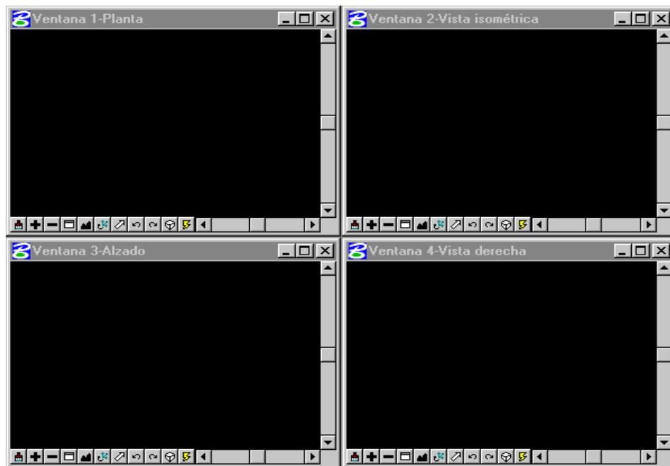
Un aspecto importante de los dibujos en tres dimensiones es el concepto de profundidad activa. Se definirá como el plano paralelo a cada vista en el cual se colocan los puntos de datos. Por ejemplo, en la vista en planta, la profundidad activa es un plano paralelo al horizontal, a una distancia que podemos ajustar según nuestras necesidades en cada momento, en el cual los puntos de datos se introducen al trabajar en esa vista.
