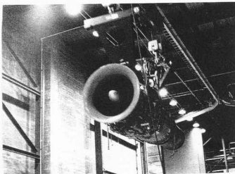
Un motor acaba de ponerse a punto, tras pasar por el túnel de ensayos, donde se prueban in vivo. Es trasladado por unas grúas que se deslizan por el techo.
